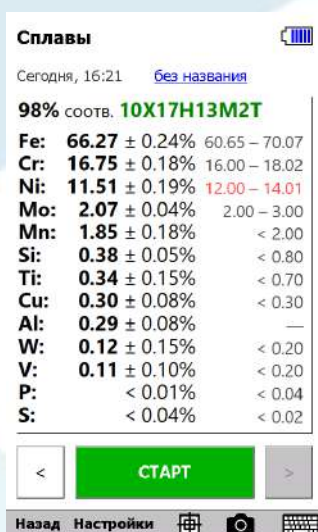
Рисунок 2. Измерение в режиме сравнения с известной маркой сплава.
